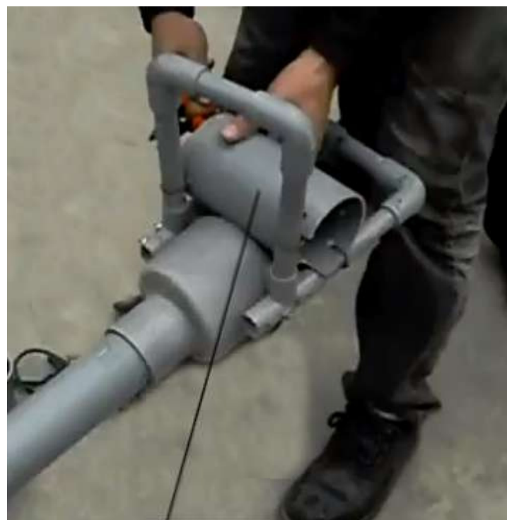
Tubo de canal para la conducción del nylon con los pistones
